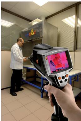
CO<sub>2</sub>, NO, NO<sub>2</sub>, SO<sub>2</sub> y H<sub>2</sub>S. Desde septiembre, el laboratorio de Instrumentos Testo, para dar un mejor servicio a sus clientes de su cámara testo 880, así como de otros fabricantes, incorpora la calibración de una nueva variable: temperatura sin contacto para cámaras termográficas. La calibración se ofrece en el rango de 0 a +350 °C, con la posibilidad de escoger los puntos específicos de temperatura o repartidos en el rango de medición.
