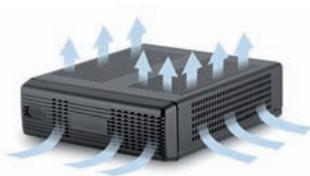
Este modelo está pensado para utilizarse sin ventiladores, aprovechando la disipación por convección natural de todos sus componentes. Para ello, se ayuda de las rejillas con multitud de pequeños orificios, situadas en los laterales y la parte superior. No obstante, ofrece la posibilidad de instalarlos, para incrementar la refrigeración, en caso de que fuera necesario.
