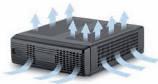
Este modelo está pensado para utilizarse sin ventiladores, aprovechando la disipación por convección natural de todos sus componentes. Para ello, se ayuda de las rejillas con multitud de pequeños orificios, situadas en los laterales y la parte superior. No obstante, ofrece la posibilidad de instalarlos, para incrementar la refrigeración, en caso de que fuera necesario.
