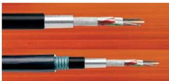
Estos cables, con capacidad para alojar hasta seis tubos activos y 48 fibras ópticas, se caracterizan por una construcción holgada con elemento central (GRP), fibras ópticas, tubo relleno de gel, cinta de aluminio y cubierta exterior de polietileno en color negro. También existe la opción de una cubierta termoplástica exterior LSZH retardante a la llama.
