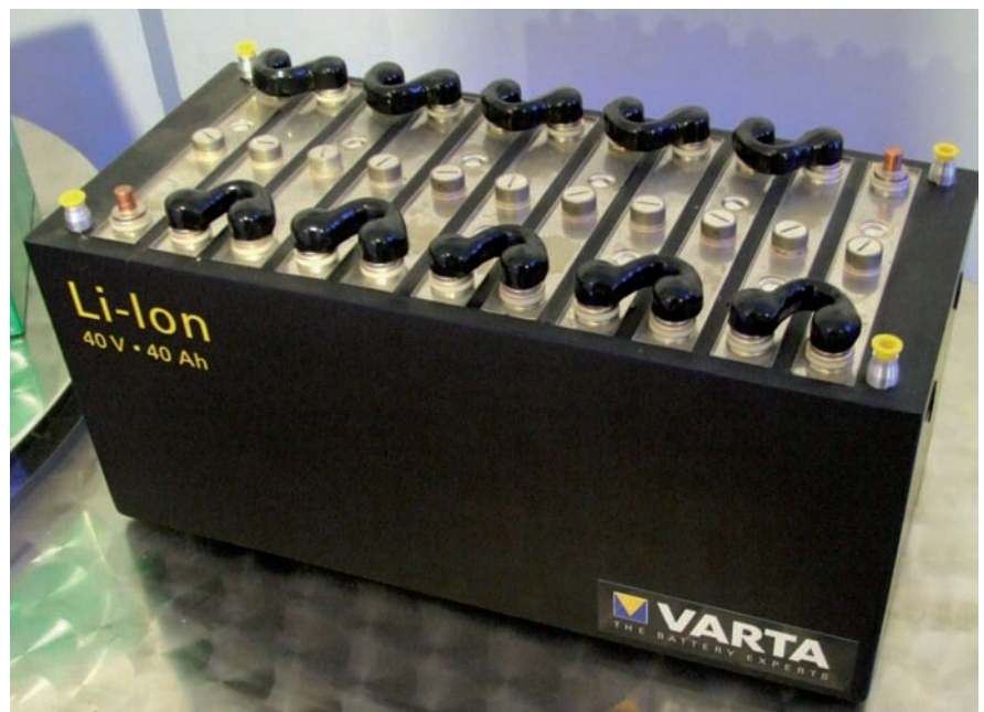
Batería de iones de litio para un automóvil eléctrico, derivada de las que se utilizan en teléfonos y ordenadores.
