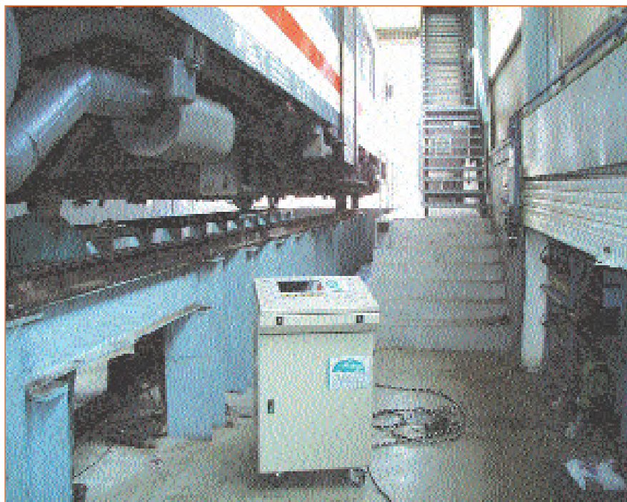
Figura 1. Equipo de monitorizado de motores en el Centro de Diagnóstico del CGM de Valencia.
