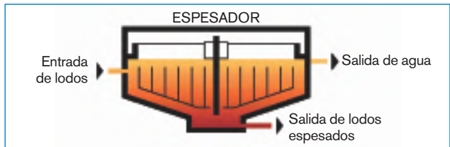
Figura 2. Decantador espesador por gravedad.
