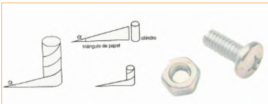
Figura 2. Construcción del tornillo de Arquímedes.
