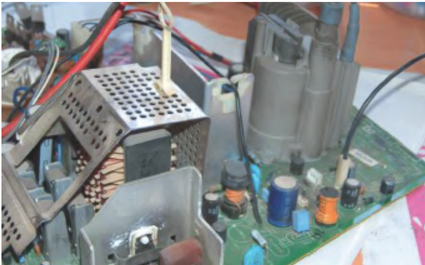
Figura 5. Transformador de líneas y circuitos asociados.
