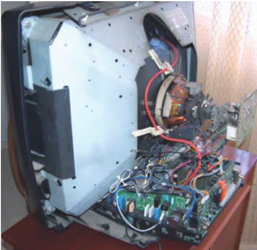
Figura 1. Interior de un televisor en color.
