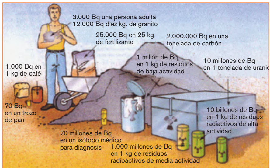
Figura 8. Contenido radioactivo en Becquerel (o desintegración por segundo) de distintos materiales naturales y artificiales.
