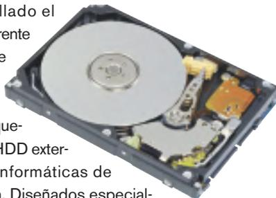
la potencia y las prestaciones de sus homólogos de sobremesa. MHV2200BT incorpora también un acelerador de *hardware* que maximiza el rendimiento de NCQ (Native Command Queuing), una importante función que permite que el controlador del disco duro establezca colas y reordene, de forma simultánea e inteligente, hasta 32 instrucciones, lo que mejora significativamente sus prestaciones generales.
