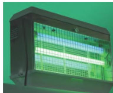
EX de Insectron cuenta con certificación ATEX para uso en ambientes explosivos, polvorientos y húmedos. Ofrece protección del grado IP65 y es apropiada para áreas en que se rocíe agua o donde la acumulación de grandes cantidades de polvo o pólvora podría producir una explosión si se utilizara una rejilla de alta tensión.
