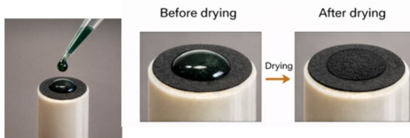
Figura 2. Deposición de tinta de material activo sobre la superficie activa de un electrodo de carbono vitreo.
