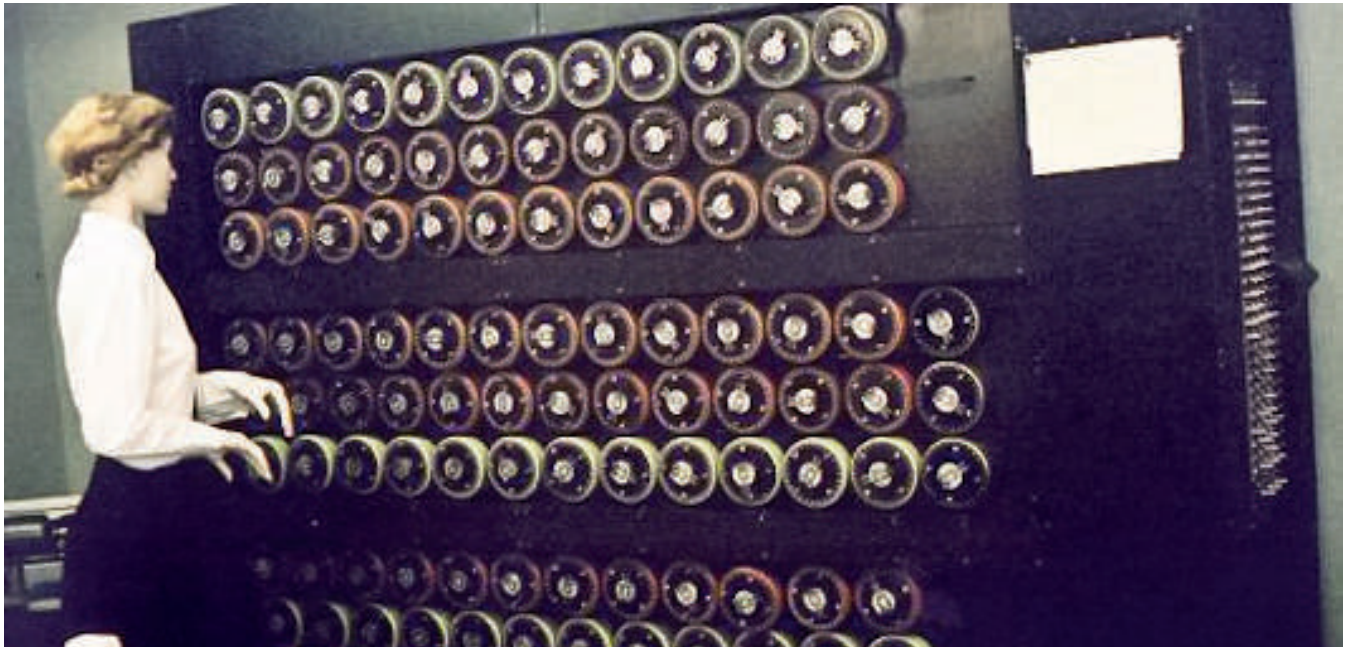
La máquina electromecánica "Bombe" replicaba la acción de varias máquinas Enigma. Fuente: Wikimedia Commons/Messybeast/CC BY-SA 3.0.
