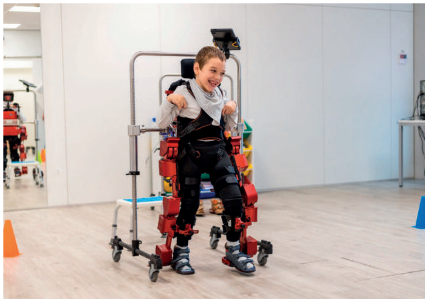
La rehabilitación con el exoesqueleto pediátrico ATLAS 2030 permite recuperar la verticalidad, entrenar el equilibrio y reforzar la musculatura. Fuente: Marsi Bionics.
