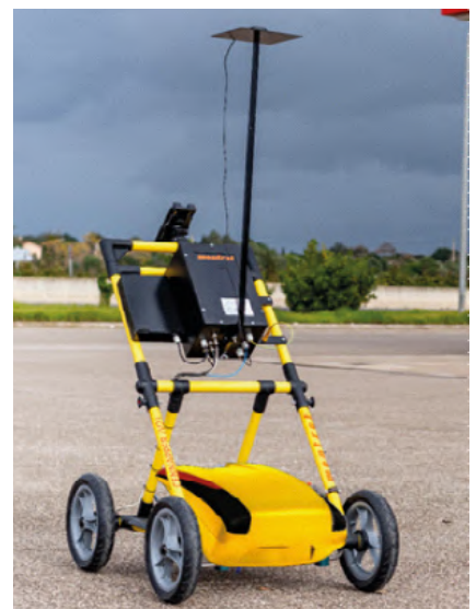
Equipo CENmapper, de GeoCENmap, para medición del campo eléctrico a nivel de la superficie.
