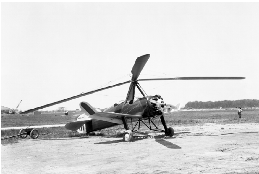
Pitcairn PCA-2 autogiro (NACA44), volado en Langley para la investigación NACA de un sistema de rotor. (Foto: NASA/NACA, LARC, https://commons.wikimedia.org/w/index.php?curid=510393 )
