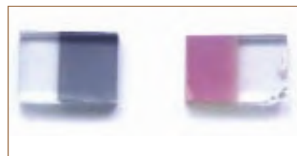
Figura 15. Electrodos de la célula fotoelectroquímica sintetizada.
