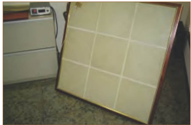
Figura 14. Panel de 9 baldosas (1 m 2 ) capaces de generar calor.
