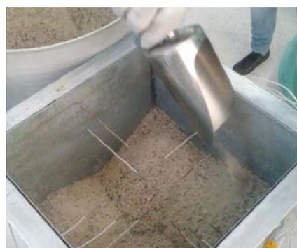
Figura 4. Llenado del depósito monitorizado con el suelo arenoso artificialmente contaminado.
