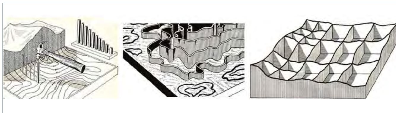
Figura 1. (De izquierda a derecha) Método de los clavos, método de la cinta y método de la caja de huevos. (United States. Department of the Army., 1956)
