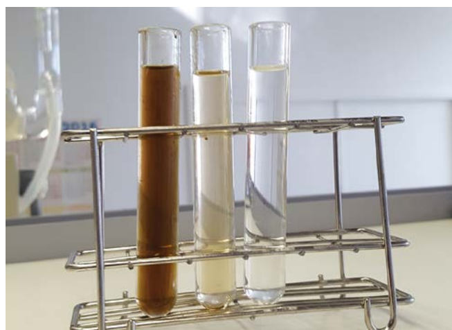
Figura 3. Evaluación subjetiva por parte del operario del grado de extracciones necesarias en función de la claridad del disolvente de extracción.
